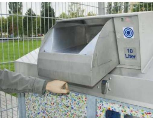
Erst nach der Identifizierung mittels Transponder kann die Müllschleuse geöffnet werden
