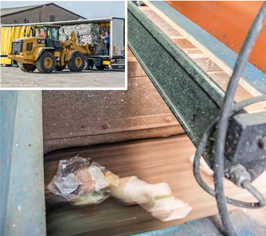
Der Nahinfrarotscanner prüft das Reflexionsverhalten der Wertstoffe (großes Bild). Gut sortiert werden die Wertstoffe auf die Reise geschickt.
